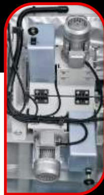
gruppo smussi chiuso closed bevelling spindles group
