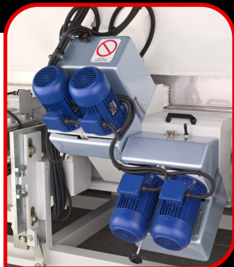
Gruppo smussi chiuso Closed bevelling spindles group
