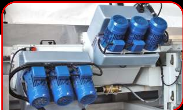
gruppo 6 smussi chiuso closed 6 bevelling spindles group
